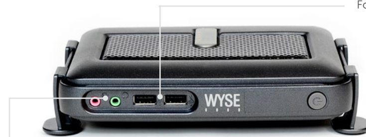
Audio in: 1/8-inch mini jack, 8 bit stereo microphone Audio out: 1/8-inch mini jack, 16 bit stereo
